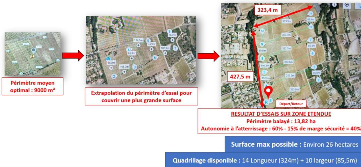
Fig. 28 : Extrapolation des essais scénarisés - Exemple de quadrillage d'un site privé à surveiller by DAE System©
